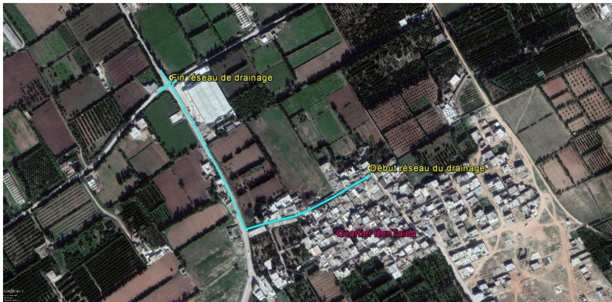
Figure 5-2: Le réseau de drainage prévu pour le quartier d'Echrfet au niveau du zone Ben Taieb
